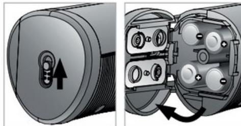
Pro instalaci baterií posuňte tlačítko na spodní straně přístroje a otevřete kryt prostoru pro baterie. Umístěte AA baterie v jednotce se správnou konfigurací a .
